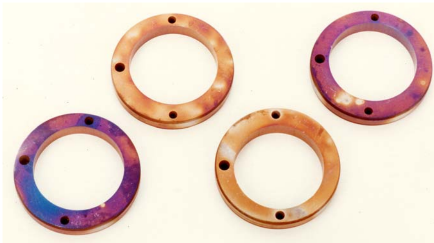
Bild 1 Verfärbung durch Oxidation nach dem Nitrieren
